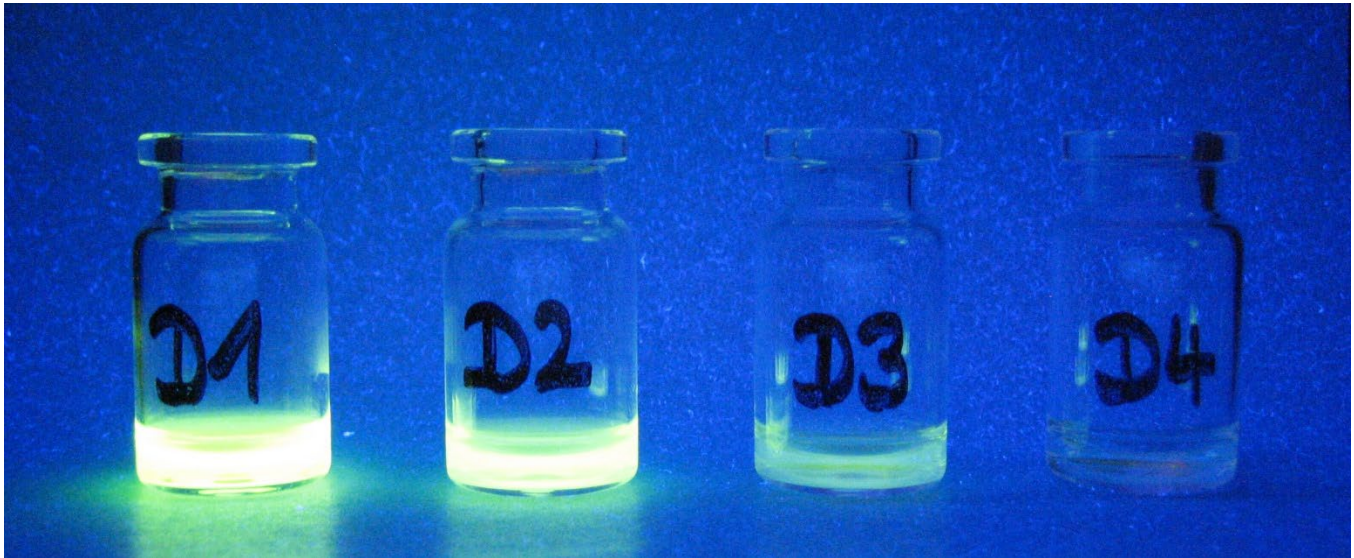
UV-Fluoreszenz von Lösungen mit unterschiedlichen Konzentrationen an Riboflavin.
